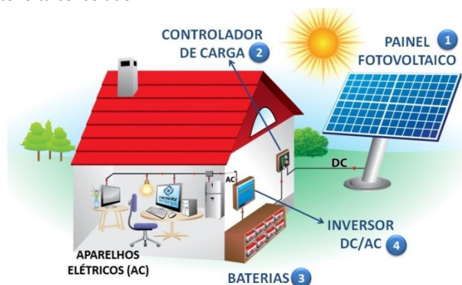
Figura 2: Sistema Fotovoltaico Isolado.
